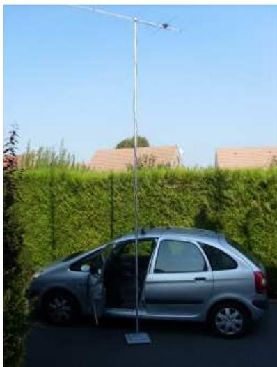
Afin de faire du trafic en portable, Gilbert F1JNK a réalisé un support de mât se fixant sur l'extrémité de la barre de toit du véhicule et reposant sur une plaque de bois, posée sur le sol.
