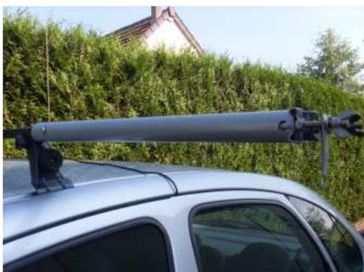
Cette barre, d'une longueur de 70 cm environ et d'un diamètre de 40 mm est un morceau de tube galvanisé provenant de mât d'antenne TV.
